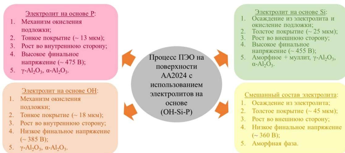
Рисунок 38 - Схематическая иллюстрация характеристик покрытий ПЭО, полученных в различных составах электролитов [12]
